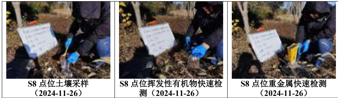
图 6-2 现场快速检测
