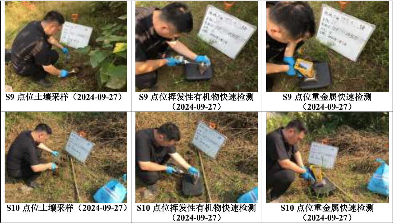
图 6-13 现场快速检测
