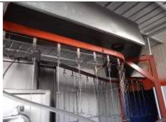
图 4-8 喷塑固化房出口集气罩
