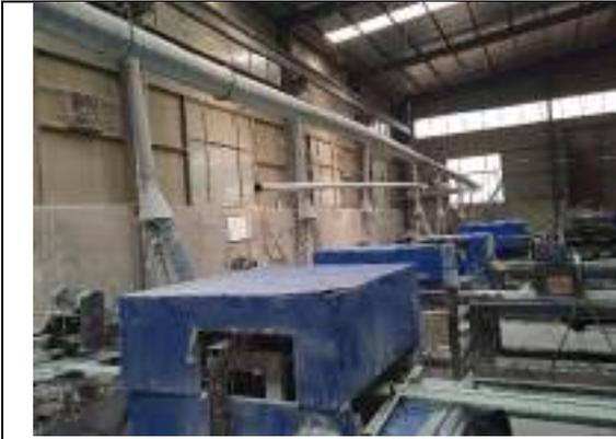
图 4-9 切割工序集气罩
