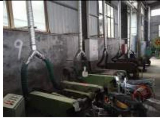
图 4-10 抛磨工序集气罩
