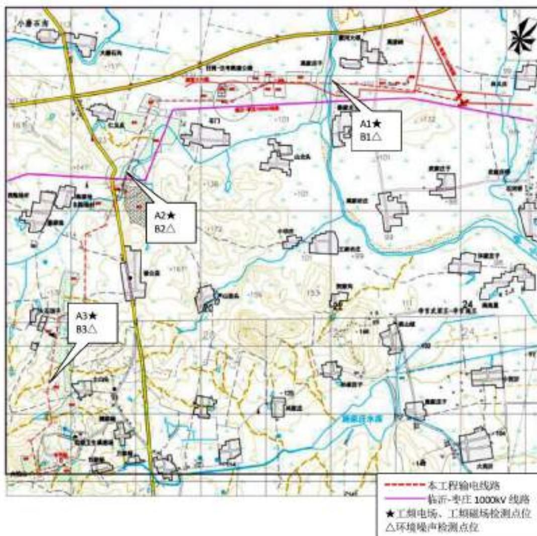
图 7-1 电磁辐射、噪声检测布点示意图一
