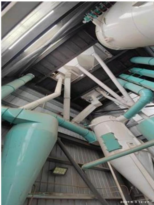
图 4-3 投料、初清筛工序除尘器
