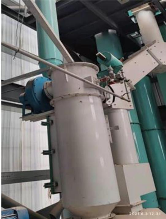
图 4-1 投料工序除尘器
