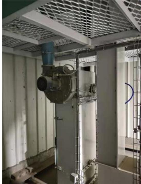
图 4-2 初清筛工序除尘器
