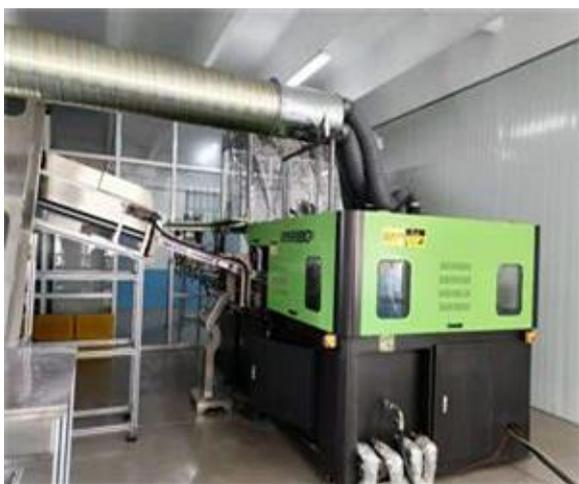
图 4-1 吹瓶机及集气管道
