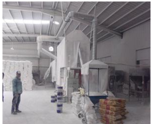
图 2-8 投料工序集气罩
